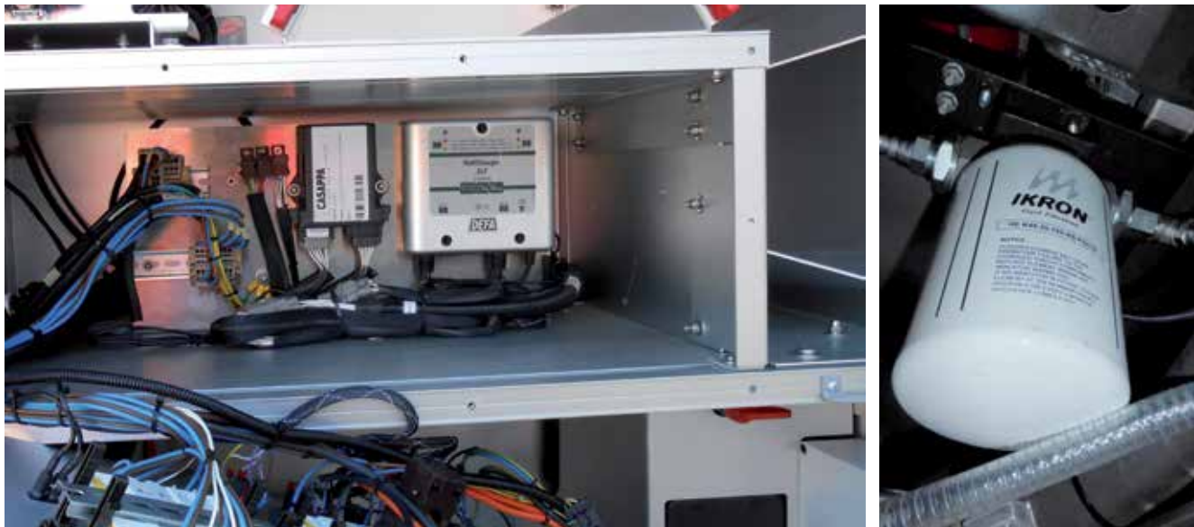
Centralina elettronica per la gestione della componentistica oleoidraulica e filtro oleoidraulico Ikrone.
