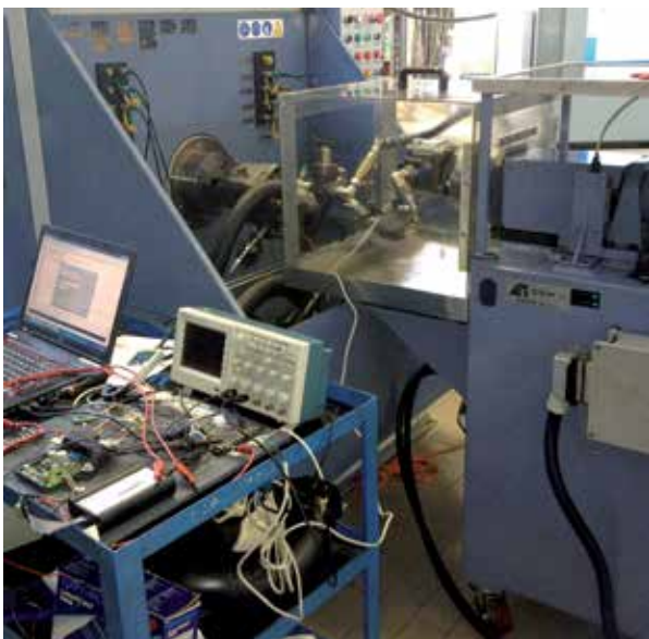
Test di messa a punto del sistema oleidraulico Casappa.
