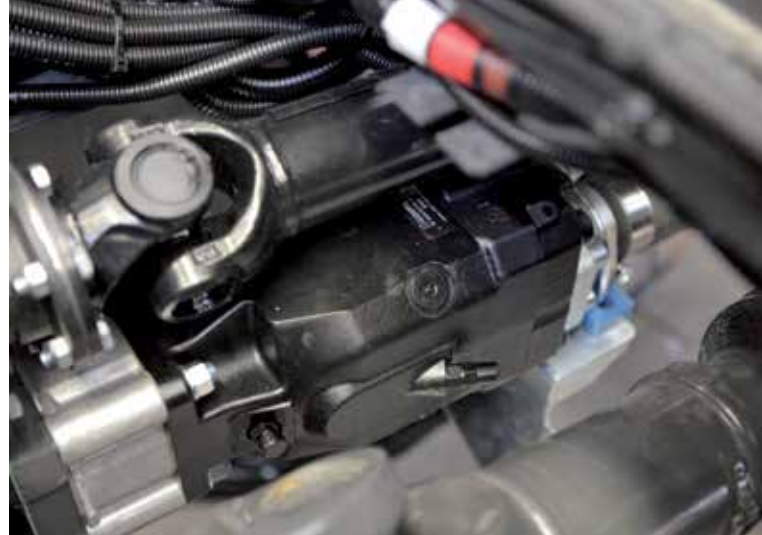
Motore oleoidraulico a cilindrata fissa Casappa, equipaggiato con sensore di velocità e una pompa a pistoni a cilindrata variabile con controllo elettronico della cilindrata.
